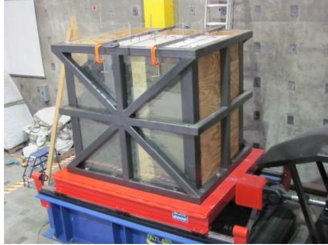
(a) – الهيكل المعدني الخارجي المحيط بالاطار الخشبي مثبتا على الطاولة الرجاجة
